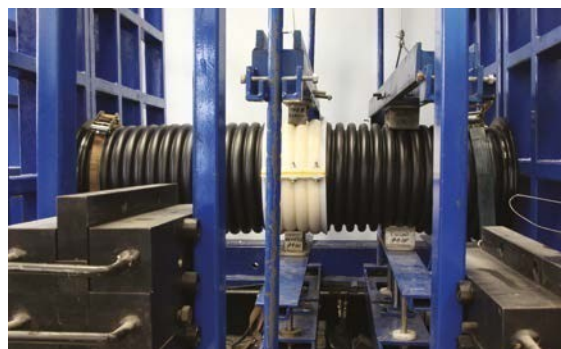
Prova di tenuta con giunto disassato
