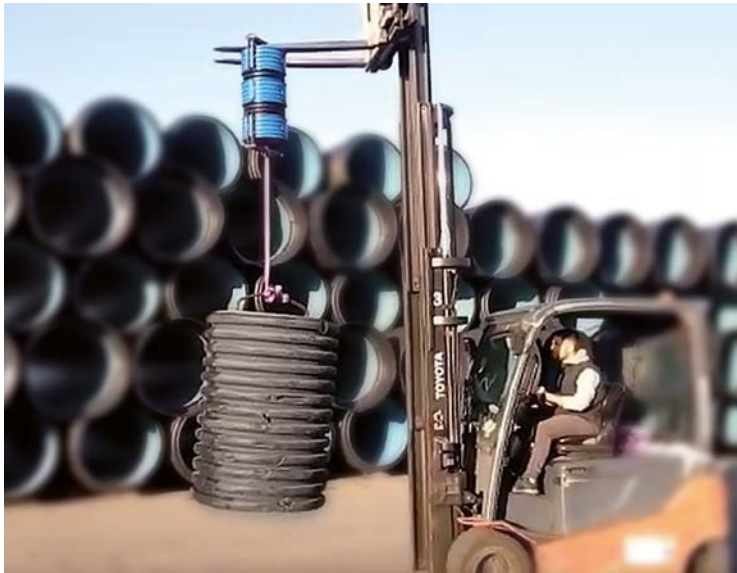
Tubi corrugati in PP DN 315 mm SN16 peso applicato > 2000 kg
